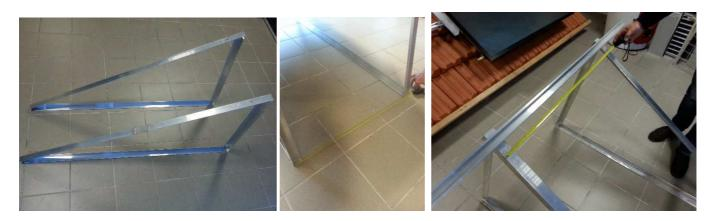
3. Posizionare il primo binario utilizzando i fori più alti presenti sul lato inclinato. POSIZIONARE IL PROFILO INFERIORE A 1 METRO DAL SUPERIORE
