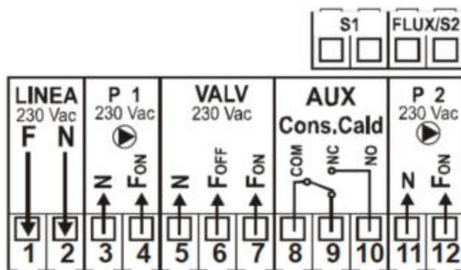
Settaggio centralina di controllo
