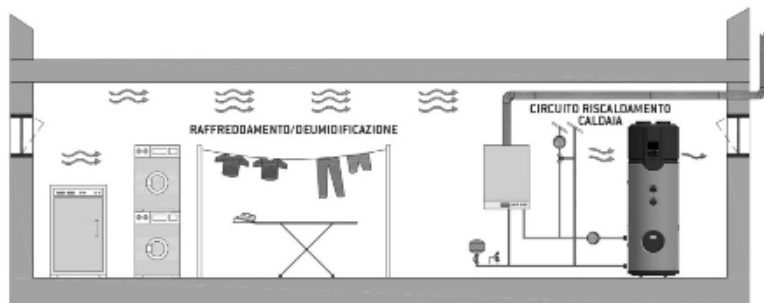
Pompe di calore per acqua sanitaria con una caldaia murale a gas
