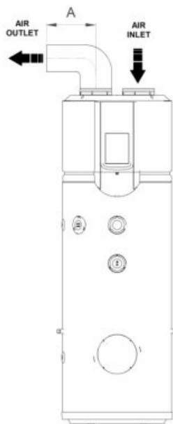
D: Espulsione canalizzata (A ≤ 5m)
