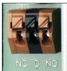
Fig. 4: Sensor box: dettaglio della morsettiera interna
